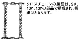
クロスチェーンの線径は、9φ、10φ、13φの部品で構成され、標準型となります。
