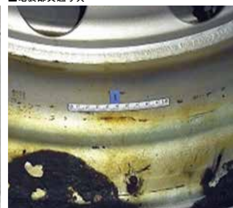
■亀裂部貫通写真
