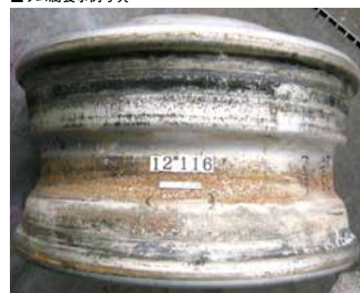
■リム腐食事例写真
